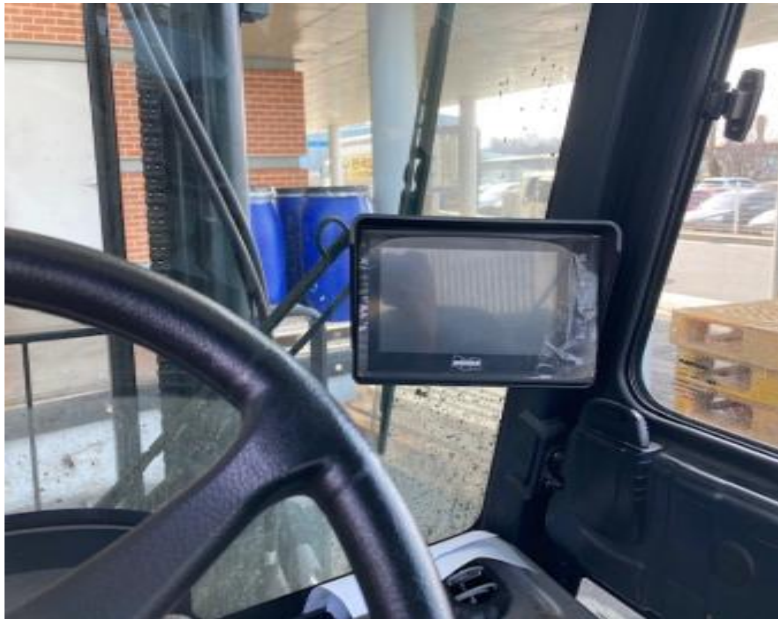
〈지게차 후방카메라 설치〉
